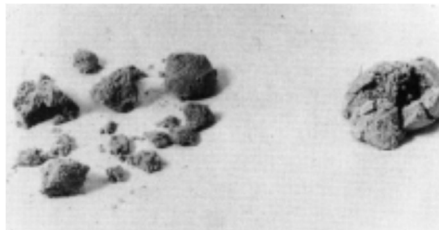
Figuur 2.84: Valproef kleefzand. Links is goed, rechts is fout.
