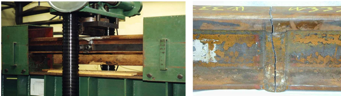
Figuur 1.25: Buig-breekproef van een gelaste spoorstaaf
