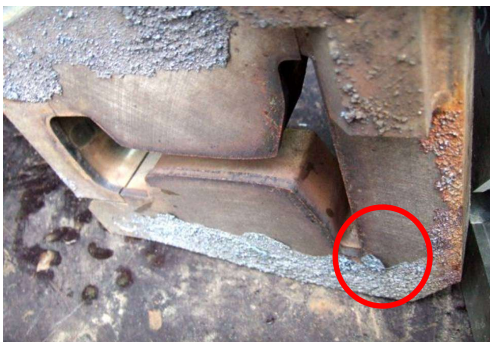
Figuur 2.100: Gebruikt mes van een mobiele afbrandstuikmachine
