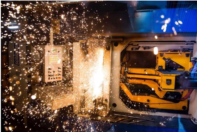
Figuur 2.81: Stationaire afbrandstuikinstallatie
