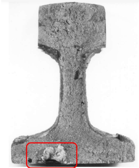
Figuur 1.66b: Niet metallische insluiting bij een thermietlas (ref.nr. 304)
