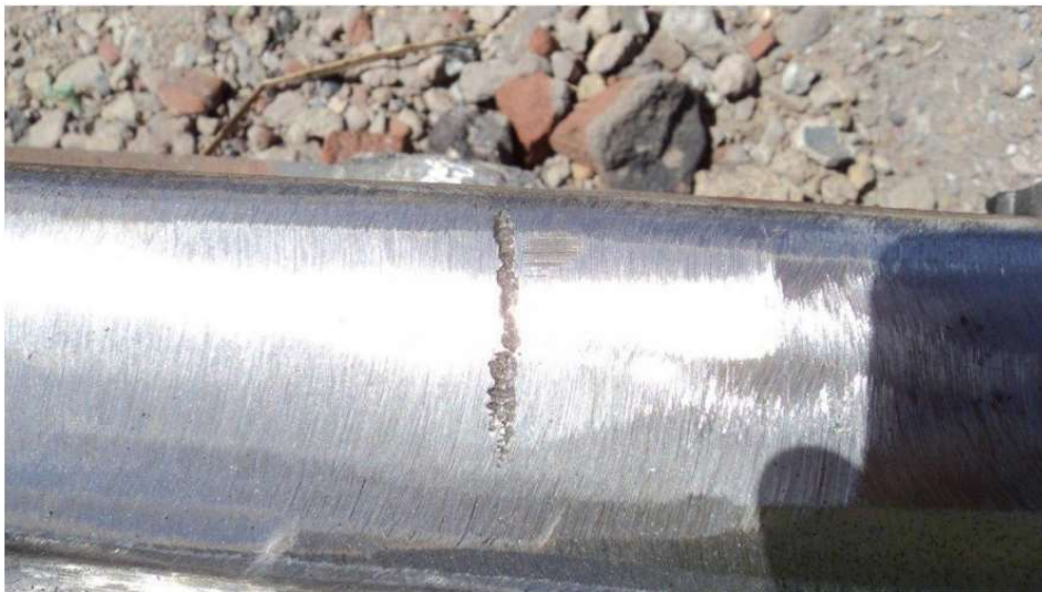
Figuur 1.66c: Ingebrand zand (ref.nr. 304)
