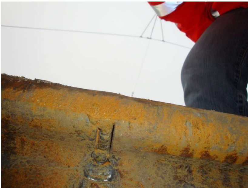
Figuur 1.71: Onvolkomen doorlassing kop bij een bekistlas (ref.nr. 4021)
