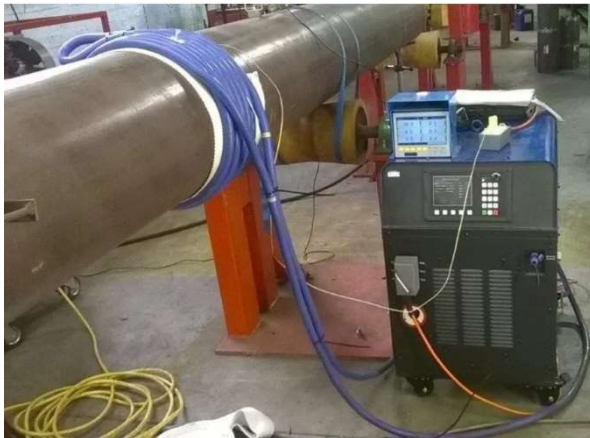
Figuur 2.91: Inductief voorverwarmen van een buis
