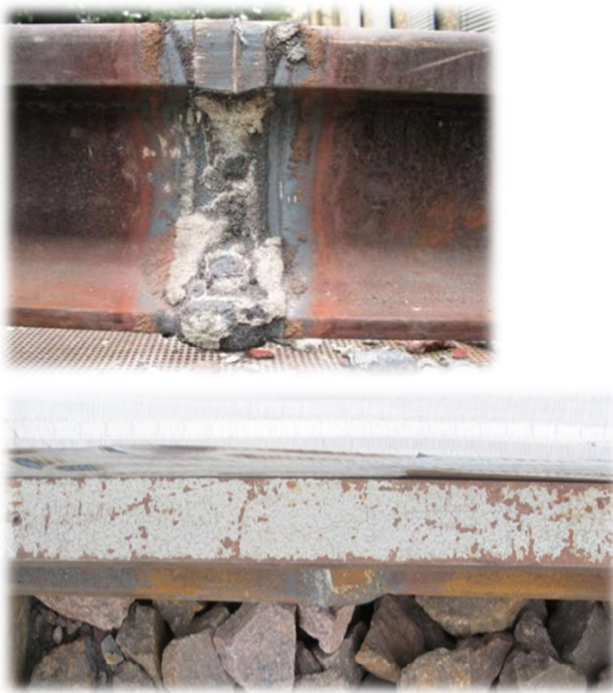
Figuur 1.80: Vormafwijking bij thermietlas
