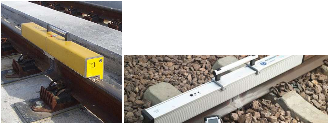
Figuur 2.70: Het meten van de geometrie met een digitale meetrei
