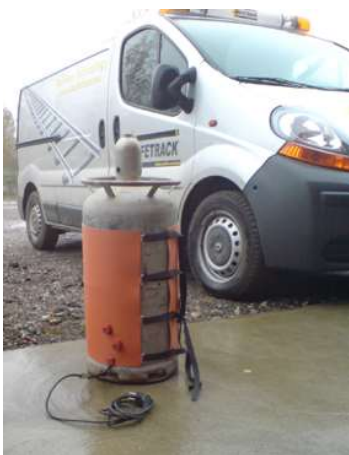
Figuur 2.40: Verwarmingsmantel voor propaancilinder
