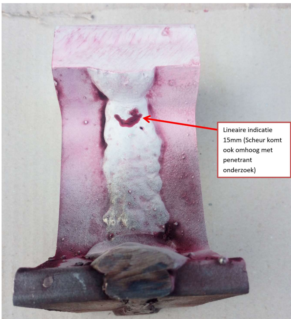
Figuur 1.59: Scheuren in een bekistlas (ref.nr. 100)
