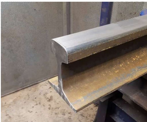
Figuur 2.85: Mechanisch gereinigd oppervlak van de kopse kant
