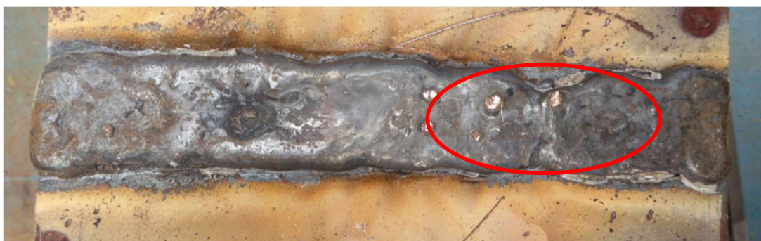
Figuur 1.66a: Koperinsluiting in de doorlassing van een bekistlas (ref.nr. 304)
