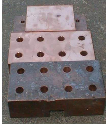
Figuur 2.97: Vervuilde en schone elektrodeblokken
