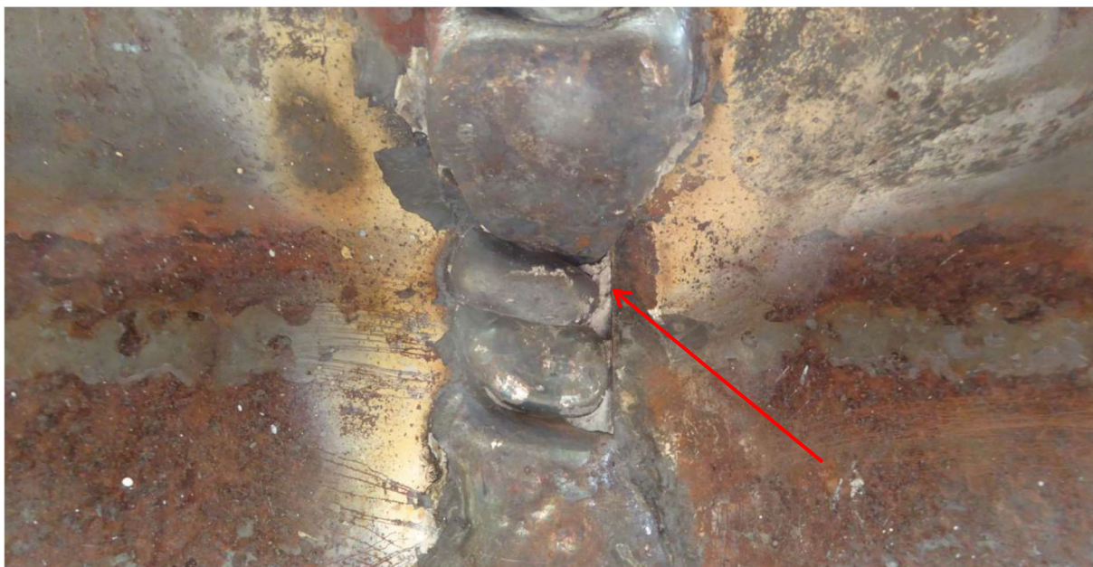
Figuur 1.67: Bindingsfout met slakinsluiting in een bekistlas (ref.nr. 401)
