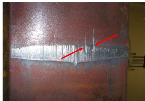
Figuur 2.102: Afschuijfout in voet (beschadigd mes)
