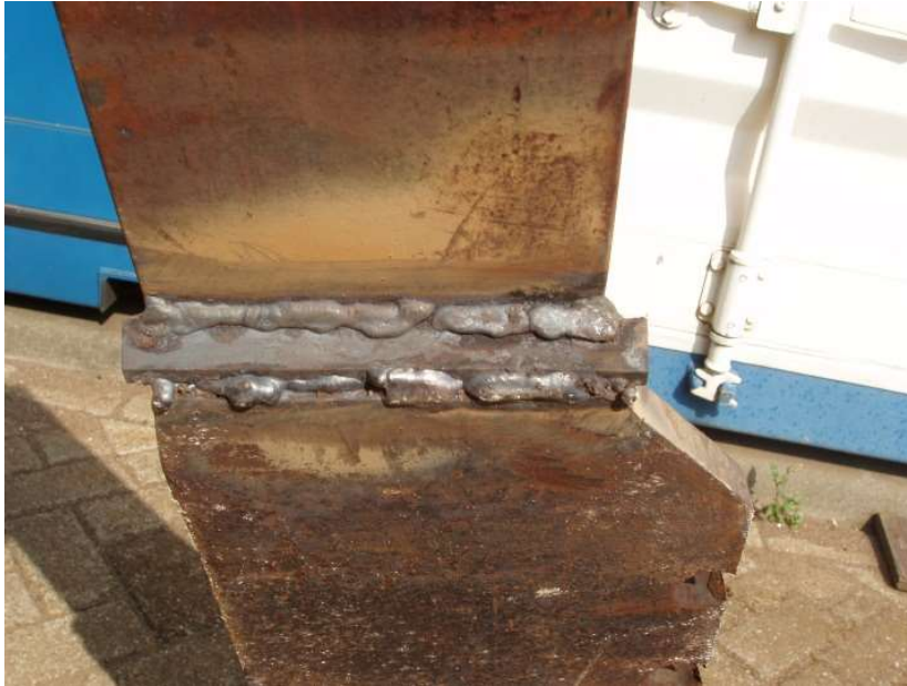
Figuur 1.70: Bindingsfout voet bij een Mn-C bekistlas (ref.nr. 401)
