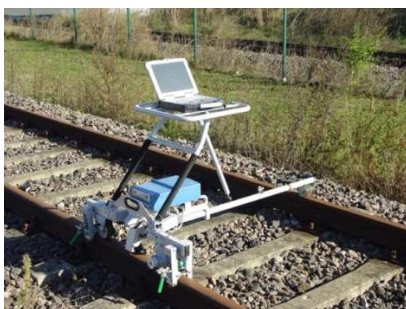
Figuur 1.54: Wervelstroom onderzoek in het spoor
