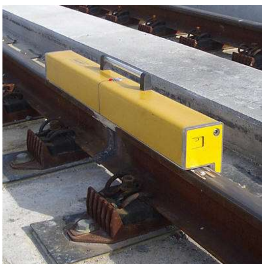
Figuur 2.90: Het meten van de geometrie van een geslepen thermielas
